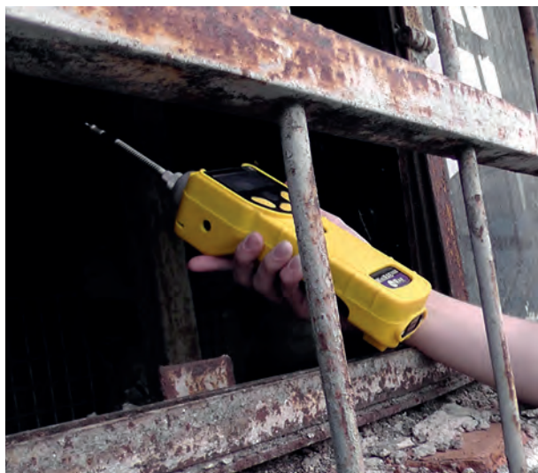
fot. 8.1 Przenośny analizator lotnych związków organicznych będący na wyposażeniu mobilnego laboratorium
