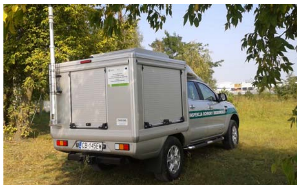
Fot. 8.1 Laboratorium mobilne do szybkiej oceny ryzyka z detektorem zdalnym chmury substancji niebezpiecznych
