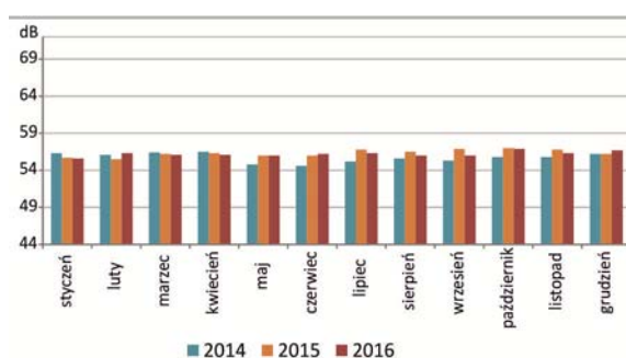
Ryc. 4.10. Zmiany długookresowego poziomu dźwięku L_N przy ul. Okrzei we Włocławku w latach 2014-2016
